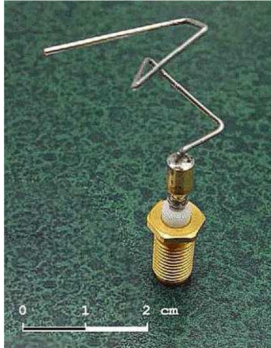
Fig. 9.1 用GA算法设计的2016 NASA ST5宇宙飞船天线，称为‘演化天线’（Evolved Antenna）。
