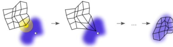
Fig. 3.12 Kohonen网络训练过程。给定一个训练数据，如图中白点所示，训练过程将对应的BMU及其相邻结点往该训练数据方向拉动。这一过程对所有数据循环迭代进行，直到网络结点中的向量可充分代表训练数据。图片来源于Wikipedia 7 。
