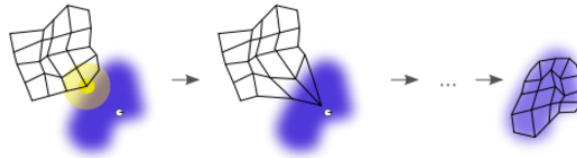
Fig. 1.19 Kohonen网络训练过程。给定一个训练数据，如图中白色点所示，训练过程将对应的BMU及其相近结点往该训练数据方向拉动。这一过程对所有数据循环迭代进行，直到网络结点中的向量可充分代表训练数据。
